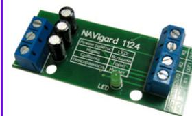
Модуль согласования двухпроводных пожарных извещателей с GSM-передатчиками NV 2050 / 292 / 293 / 2150 / 8704 и контрольными панелями NV 86XX / CADDX / DSC / PARADOX / ЛАДОГА/ ElectronicsLine / PYRONIX / Visonic / Элпром
